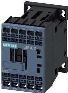
güç kontaktörü, AC-3 9 A, 4 kW / 400 V 1 NA, DC 24 V 3 kutuplu, ebat S00 yaylı bağlantı
