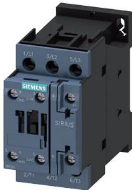
güç kontaktörü, AC-3e/AC-3, 12 A, 5,5 kW / 400 V 3 kutuplu, AC 230 V, 50 Hz, yardımcı kontaklar: 1 NO + 1 NC, vida tipi klemens
